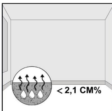
Os pisos em cimento devem ser inspecionados antes da instalação e se não corresponderem aos requisitos necessários, o pavimento não deve ser aplicado. Os pisos em cimento devem ser lisos, rígidos, nivelados e secos. A humidade do piso cimentício não pode exceder os 2,1% (referencia CM) e a humidade relativa não deve exceder os 70%. Em pisos à base de sulfato de cálcio, a
