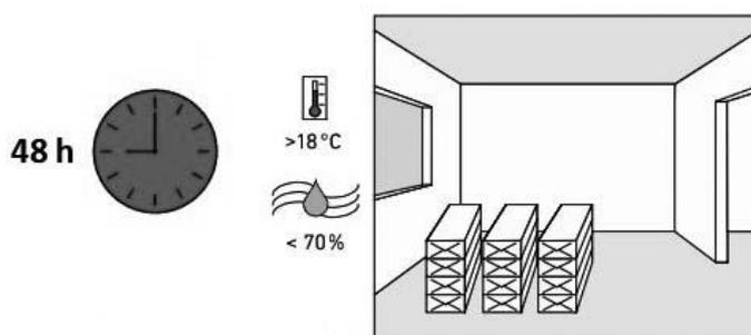
A climatização do produto é um procedimento essencial para a instalação do pavimento AKUA RIGID®. Coloque as caixas, fechadas, no compartimento onde o pretende instalar pelo menos 48 horas antes. Mantenha sempre as caixas numa superfície lisa e nivelada; nunca as deixe pousadas de lado ou na vertical. A temperatura durante a aplicação deve ser próxima da temperatura média que irá manter no espaço.
