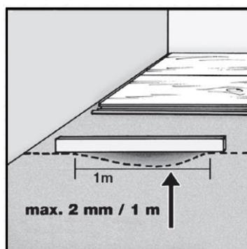
Certifique-se que o piso é totalmente nivelado. O desnível máximo admissível é de 2mm/m.
